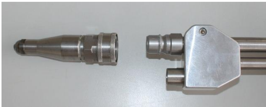
Figura 10 Boquilla micronizadora (water mist) separada de la lanza
