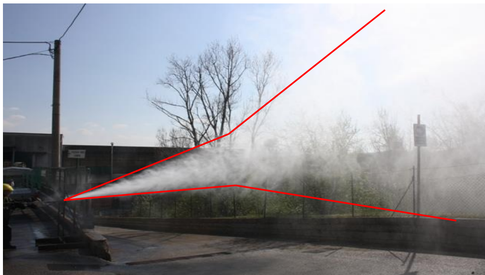
Figura 15 Chorro perforado a través del orificio del micronizador (water mist).
